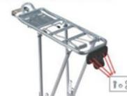
4. Anbringung der Schlussleuchte mit der Zwischenhalterung an die Halterung
