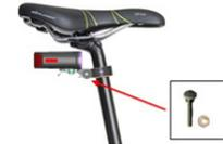
2. Befestigung der Zwischenhalterung am Rücklicht
